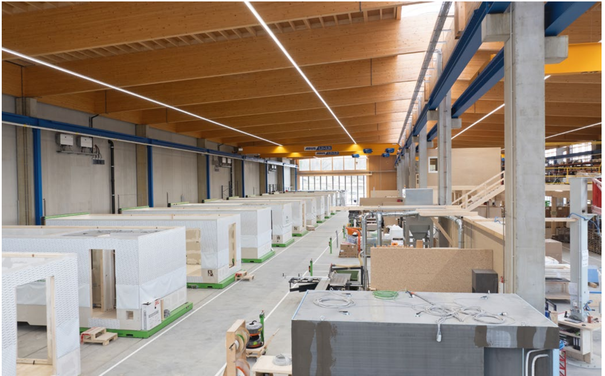
Fertigung der Holzraummodule in der Timber Homes Produktionshalle
